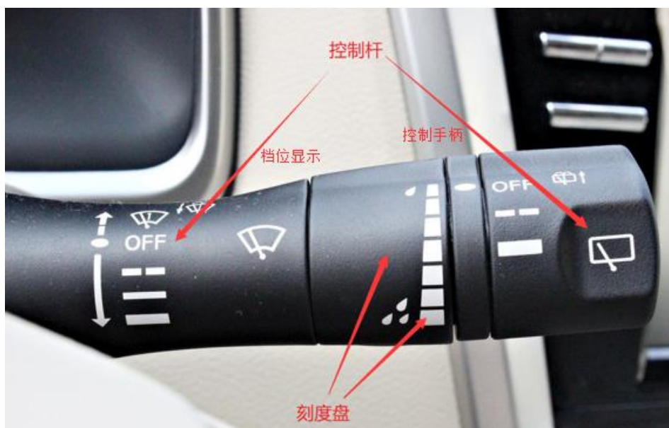
图 2 控制杆与刻度盘示意图
